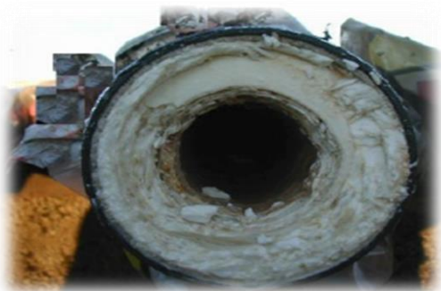
Gambar 2. Pipa yang mengandung TENORM hasil penambangan minyak[5]
