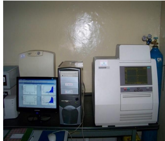
Gambar 4. TLD Reader Harshaw Tipe 6600, untuk membaca Dosimeter LiF:Mg, Cu, P.
