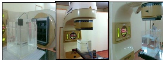
Gambar 4. a) Pengukuran menggunakan dua buah fantom air dan fantom padat.
