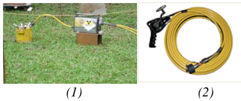
Gambar 1. Kamera gamma radiografi industri jenis portabel (1) dan alat kendali jarak jauh (2).
