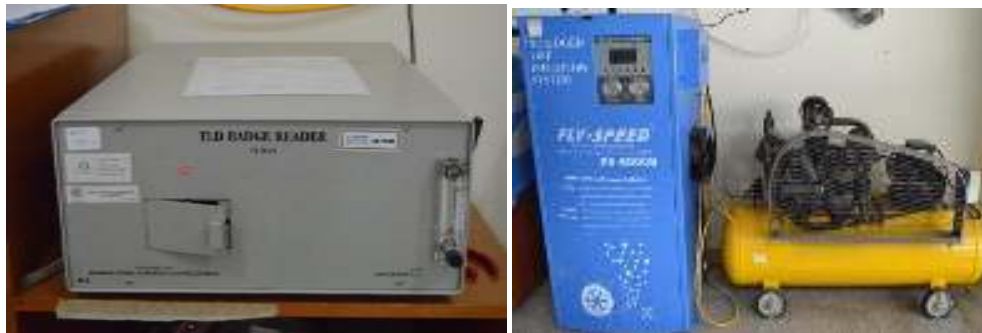
Gambar 4. TLD BARC-Reader (kiri), Gas nitrogen dan pompa gas (kanan).
