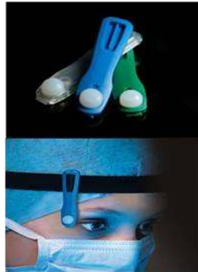
Gambar 3. 2 Dosimeter H_p(3) yang dikembangkan oleh ORAMED [2]
